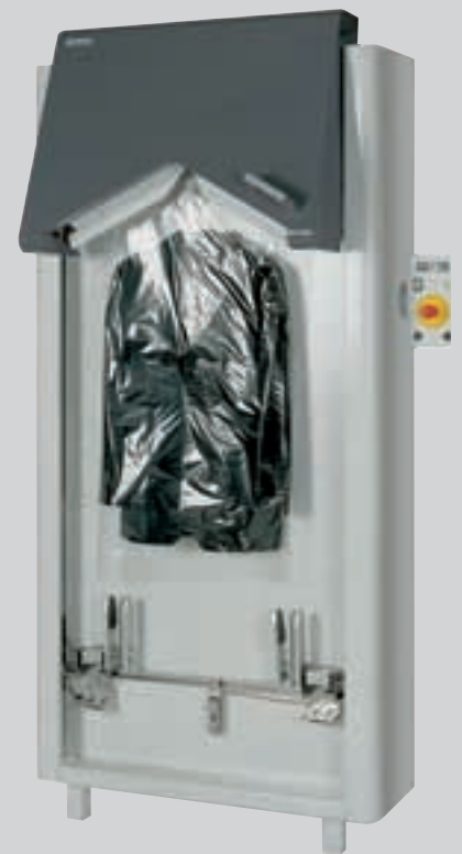
Schritt 3: Kleidungslänge und -breite werden automatisch erkannt Step 3: Length and width of garment are automatically detected Pas 3 : Longueur et largeur sont automatiquement reconnus
